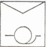
150. Motor trifásico de inducción con dos dispositivos de arranque.
