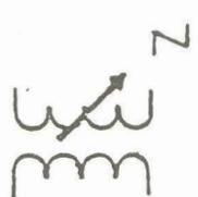
144. Transformador de dos enrollamientos con variación continua de tensión.
